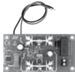
Amplificador de voltaje para placas solares de 50W. cód. ACG9125
