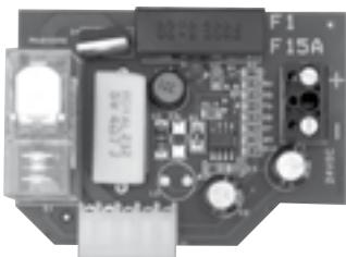
Il tempo di ricarica completa delle batterie da 12Vdc 1,2Ah (n° 2 pezzi collegati in serie, opzionale cod. ACG9511), alla prima installazione è di 24 ore, con una corrente di carica di 0,03A.
