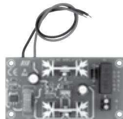
Spannungsverstärker für Sonnenplatten ab 50W.
