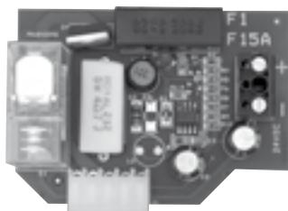
Die vollständige 12Vdc 1,2Ah-Batterie-Ladezeit (2 Stücke in Serie angeschlossen, optional Kode ACG9511) beträgt bei der ersten Installation 24 Stunden, mit einer Stromladung von 0,03A.
