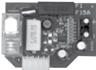
El tiempo de carga completa de las baterías de 12Vdc 1,2Ah (nº 2 piezas conectadas en serie, opcional cód. ACG9511), para la primera instalación y de 24 horas, con una corriente de carga de 0,03A.
