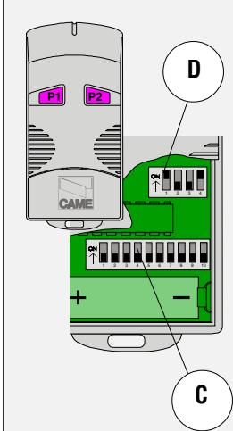
saisir le code sur le commutateur dip C et le canal sur D (P1=CH1 et P2=CH2,
