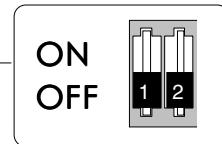
**«1 OFF» "Homme mort", fonctionnement du portail en maintenant appuyé le bouton-poussoir (exclut la fonction de la radiocommande) éteinte; (1 ON - activé)**
