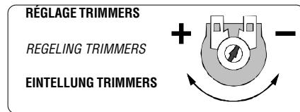
**Trimmer T.L. = Réglage du temps de travail d'un minimum de 5 secondes à un maximum de 50 secondes.**
