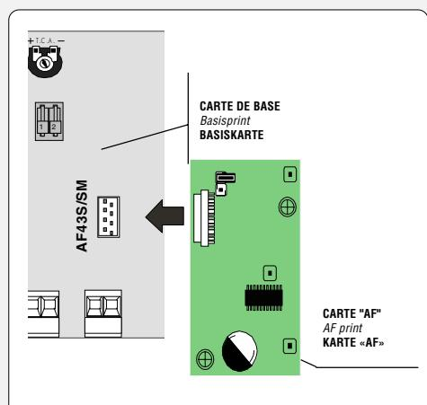
(\*\*) Pour les émetteurs de fréquence 433.92 AM (série TOP et série TAM) il faut positionner le pontet sur la carte AF43S correspondante de la façon indiquée.
