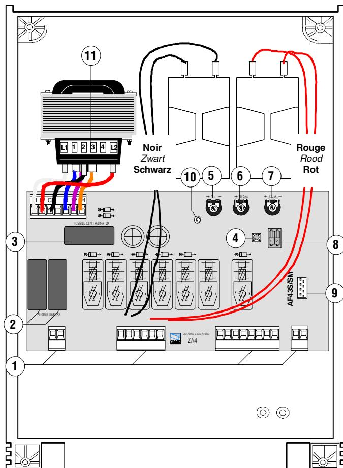
Note: série FROG, connecter les fils noirs qui sortent de la carte sur les connecteurs du condensateur du 1<sup>er</sup> moteur et les fils rouges sur le condensateur du 2<sup>e</sup> moteur.
